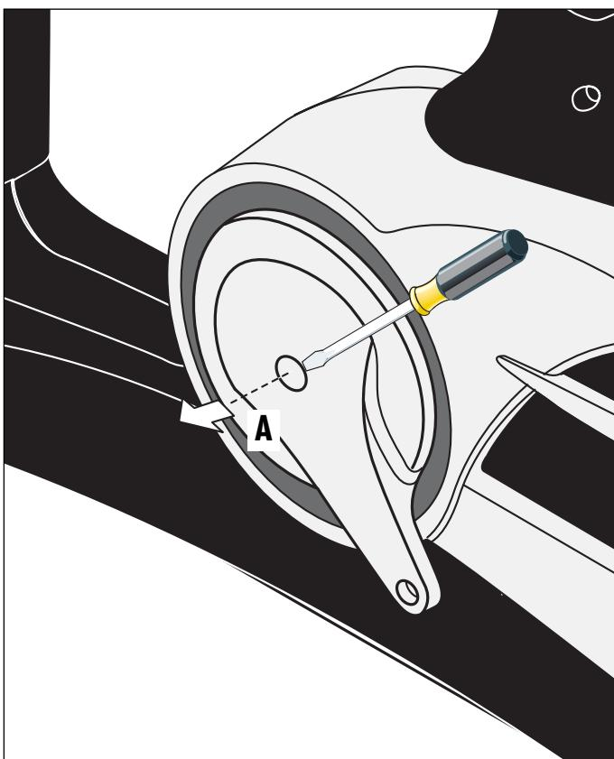
Zum Abziehen des Pedalarms entfernen Sie zuerst die Schutzkappe und Schraube (A). Halten Sie den Pedalarm fest und drehen Sie eine Schraube M12 (gehört nicht zum Lieferumfang) in die Gewindeöffnung (B). Nach einigen Umdrehungen können Sie den Pedalarm abnehmen (C).
