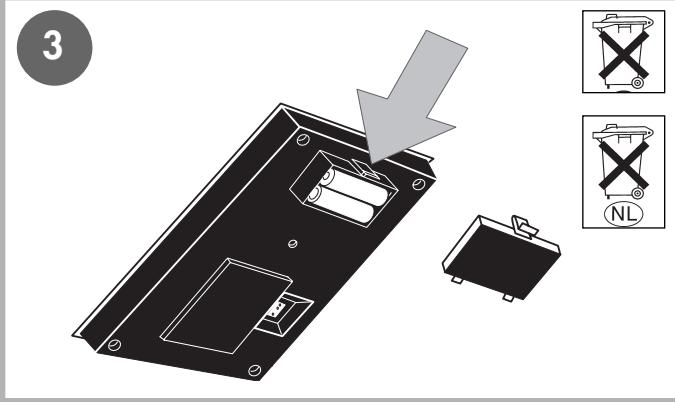
Eine schwache oder erloschene Computeranzeige macht einen Batteriewchsel erforderlich. Der Computer ist mit zwei Batterien ausgestattet. Nehmen Sie den Batteriewchsel wie folgt vor:
