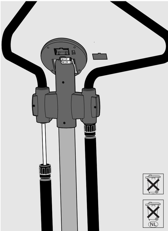
Eine schwache oder erloschene Computeranzeige macht einen Batteriewechsel erforderlich. Der Computer ist mit zwei Batterien ausgestattet. Nehmen Sie den Batteriewechsel wie folgt vor:
