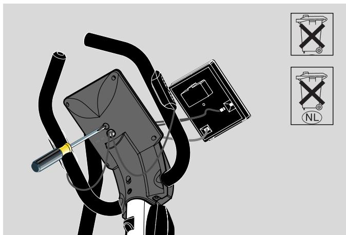
Eine schwache oder erloschene Computeranzeige macht einen Batteriewchsel erforderlich. Der Computer ist mit zwei Batterien ausgestattet. Nehmen Sie den Batteriewchsel wie folgt vor:
